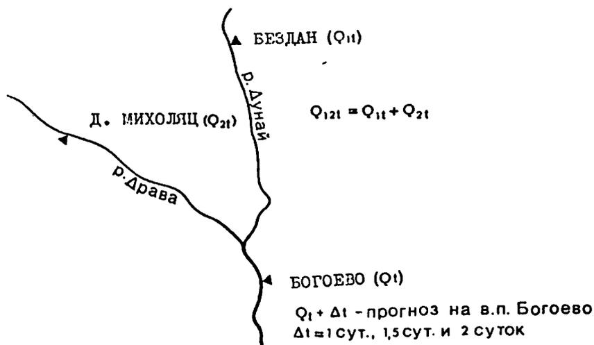
Рис.1 Схема приточного участка р. Дунай с водомерными постами, которые служат как основа для прогноза на в.п. Богоево.
