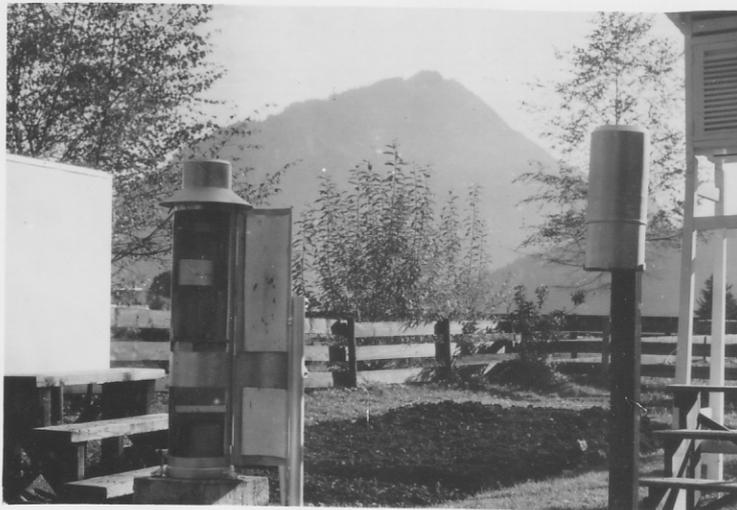
BILD 5: Autographische Niederschlagsstation
